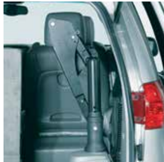
Goupilles à blocage rapide permettant de replier la tête de l'élevateur.
